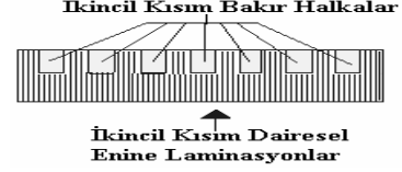
Şekil 7: Dairesel, enine laminasyonlu TYDHAM [6].
