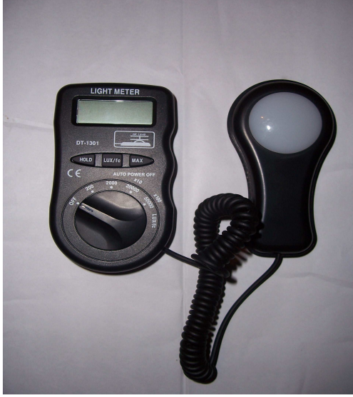
Şekil 6 Yapılan Ölçümler Sırasında Kullanılan Lüksmetre
