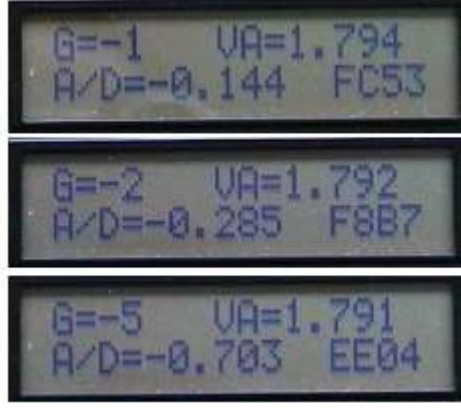
Şekil 6.25 Basit voltmetre devresi LCD gösterimi
