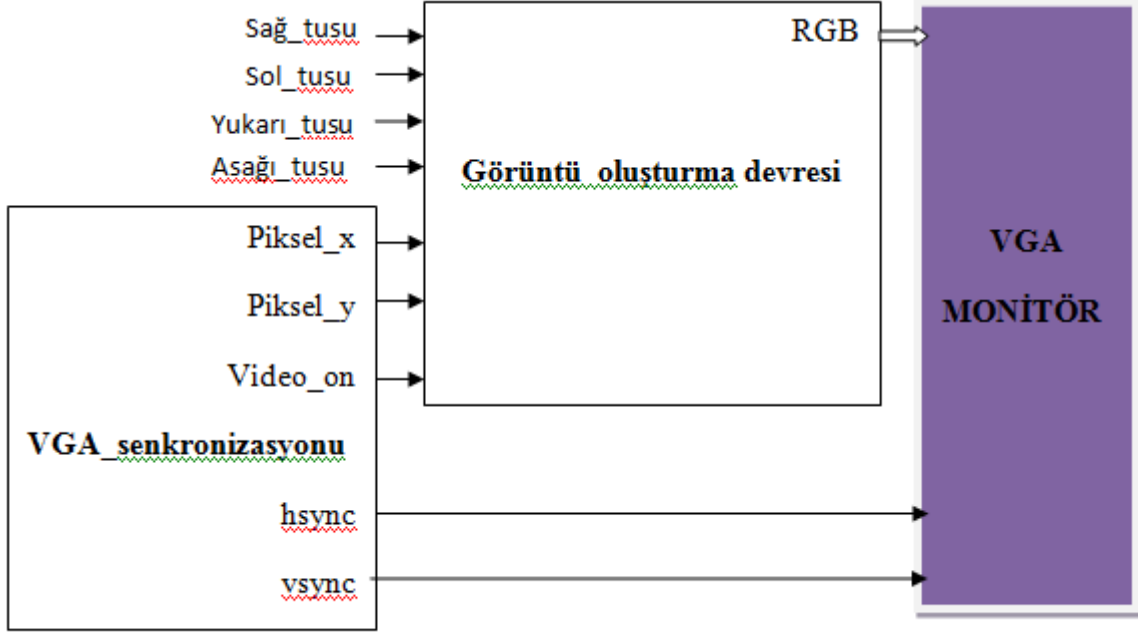
Şekil 5.6 Kaydırmalı anahtar ile hareketli şekil uygulaması blok diyagramı
