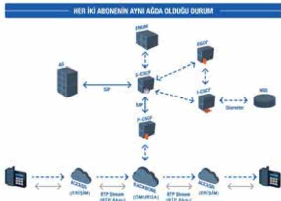
Şekil 4: IMS-IMS çağrı akışı.
