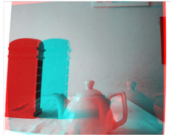
Şekil 4: Rektifikasyon işlemi sonucu elde edilen görüntü.
