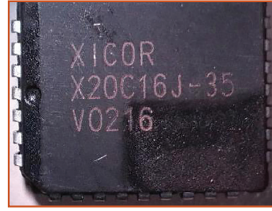
Resim 4.5. Taklit malzeme, kimyasal ile adı siliniyor.
