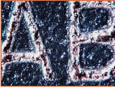
Resim 4.4. Laser ile üzeri kötü yazılmış taklit malzeme.
