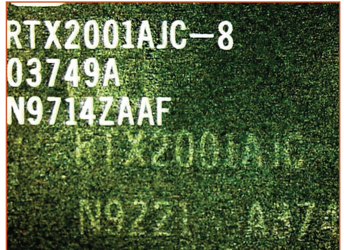
Resim 4.1. Altında orijinal yazısı silinip, yeniden isimlendirilmiş taklit veya kullanılmış malzeme.
