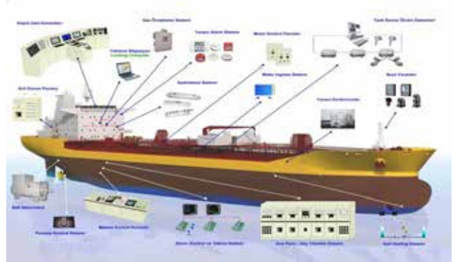
Şekil 3: Ticari bir gemideki elektrik-elektronik sistemler.
