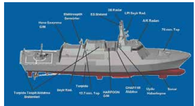
Şekil 2: Ada sınıfı korvetin silah ve elektronik sistemleri.
