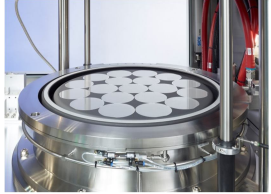
Resim 5. Aixtron firmasına ait Closed Coupled Showerhead 19x4" MOCVD (metal organik kimyasal buhar yoğunlaştırma) cihazı.
