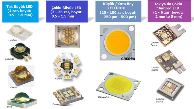
Resim 12. Farklı LED çip sayıları ve tipleri kullanılarak üretilen LED paketleri ve sınıflandırmaları.
