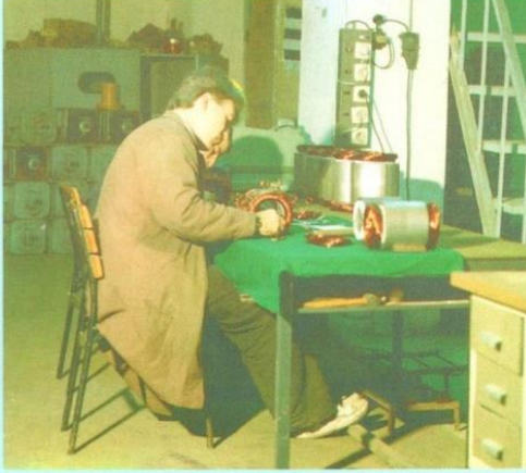
Sargı işlemleri, her motor için ayrı bir masada gerçekleşir.
