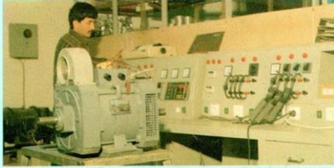
Aşansör motorlarımız, imalat sonunda bilgi işlem kontrollü olarak test edilir.
