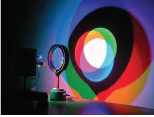
Şekil 9: 3 ana renkte LED ile ara renklerin elde edilmesi
