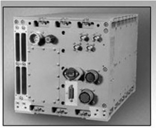
Amerikan Northrop Grumman firmasına ait "LR-100 RWR/ESM/ELINT Receiver System" görülmektedir. Uçaklara, insansız hava araçları, helikoptere monte edilebilmektedir.
