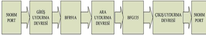
Şekil : UHF güç kuvvetlendiricisi Blok Şeması
