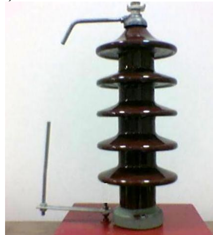
Şekil 3. Deneylerde kullanılan ark boynuzları ve 36 kV’luk transformatör tipi geçit izolatorü.
