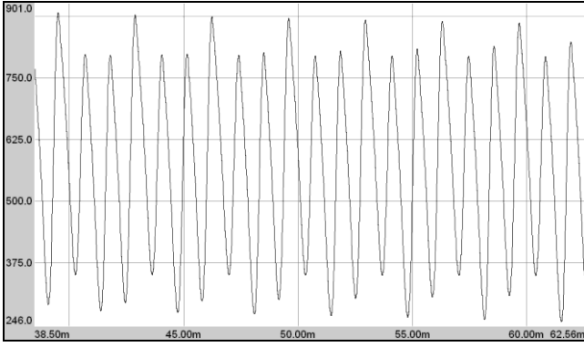
Şekil.6 37 kW sabit güçlü yükte film kondansatörlü doğrultucu DC bara gerilimi (125V/bölme, 5ms/bölme)
