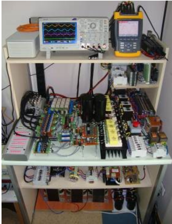
Şekil 7. 4-kollu 4-telli BSPAF sistemi laboratuvar test platformunun fotoğrafı
