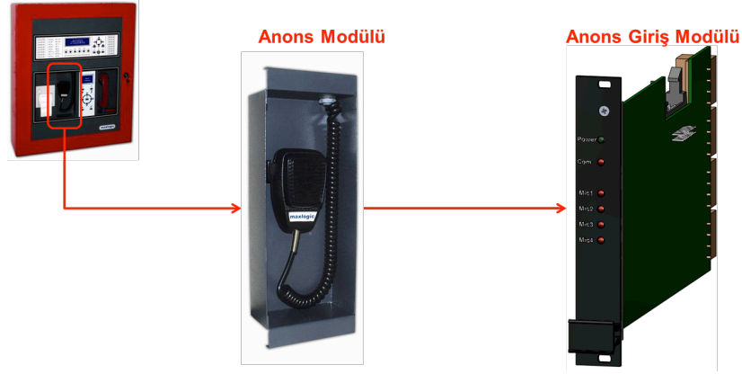
Şekil 2. Akıllı adresli yangın alarm santralleri üzerinden anons yapılması
