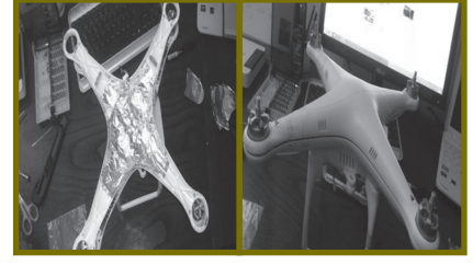
Şekil 7. Ana Kısmı İletken İle Kaplama
