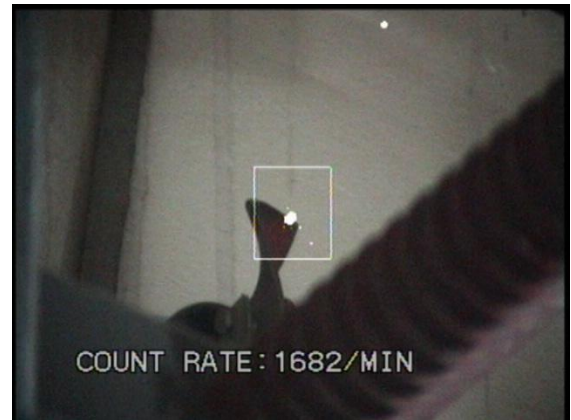
Şekil 6 Bara ucunda korona oluşumu
