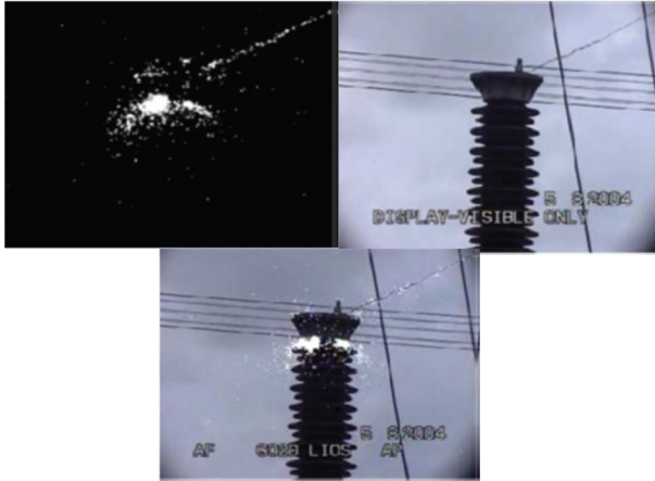
Şekil 4.Korona kamerasının çalışma prensibi
