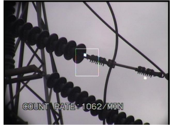
Şekil 5 TEİAŞ şaltında korona oluşumu
