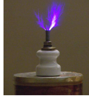
Şekil 12: Üreticinin çıkış geriliminin yarattığı elektriksel boşalmalardan bir görünüm.
