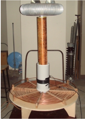
Şekil 11: Yapımı gerçekleştirilen transistor tetiklemeli Tesla üretici.
