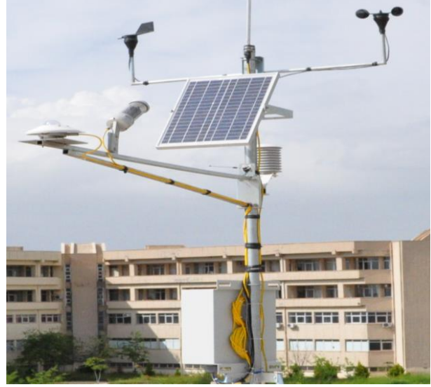
Şekil 3: Güneş Ölçüm İstasyonunun Önden Görünümü
