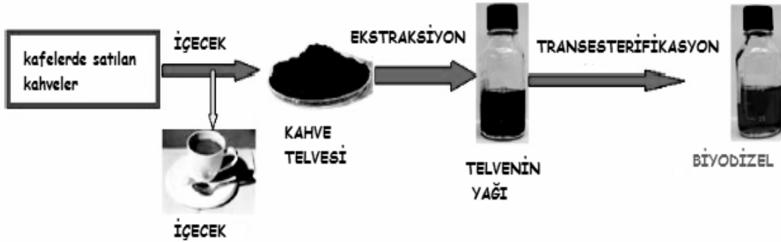
Şekil 2. Biyodizel Üretim Şeması
