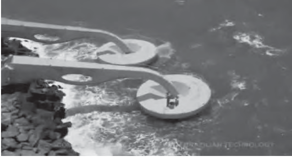
Şekil-5 Dalganın Enerjisinin Piezoelektrik Materyal ile Enerji Üretmede Uzun Kollu Şamandıra Yöntemi
