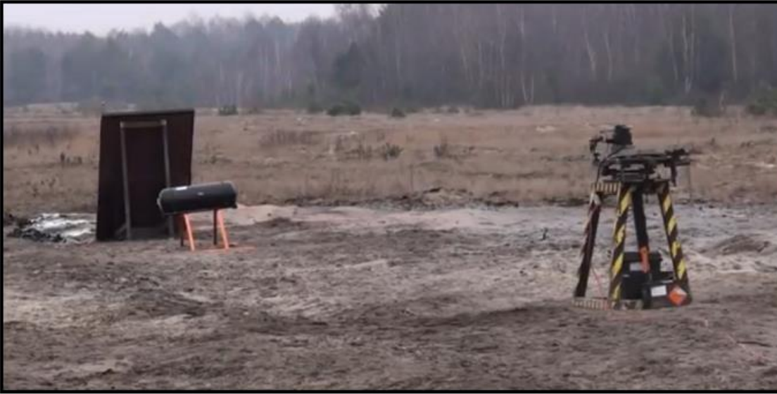
15 METRE MESAFEDEN 7.62X39 TÜFEK NAMLUSU İLE 4/1 DOLU LPG DEPOSUNA YAPILAN TEST
