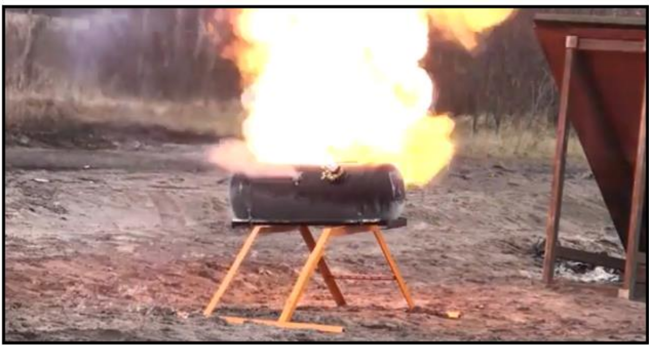
YAPILAN ATIŞ SONRASI ARKA YÜZEYDEDE BAŞLAYAN BASINÇLI ALEVLENME
