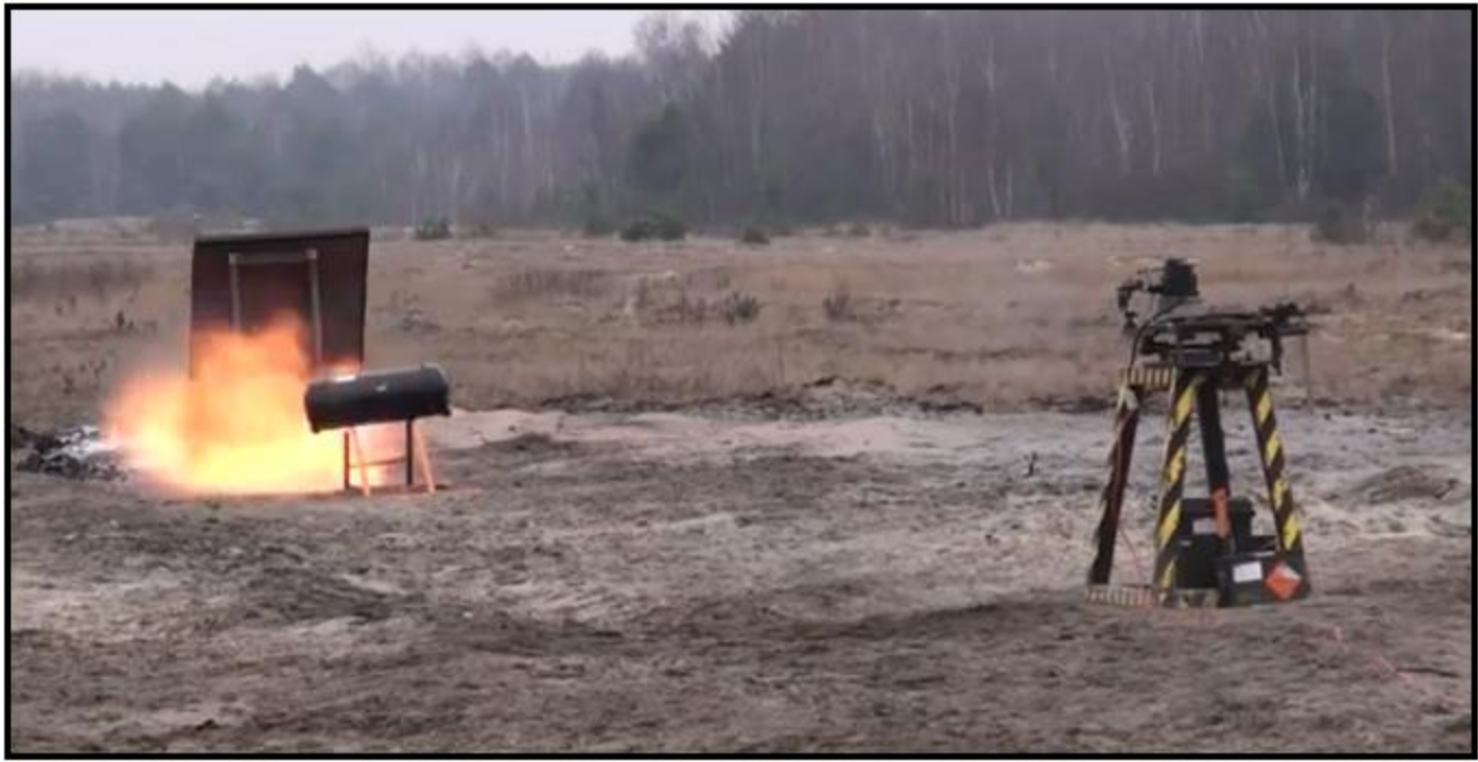
YAPILAN ATIŞ SONRASI MERMİNİN ÇIKARDIĞI KIVILCIM İLE ALEV ALAN YAKIT TANKI
