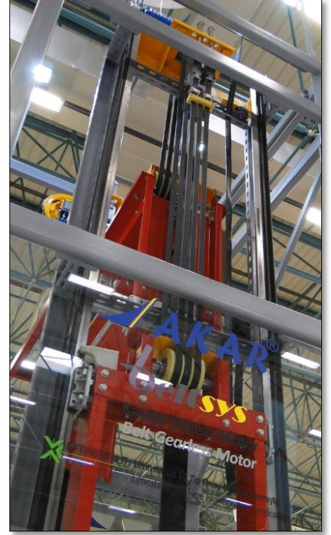
Şekil 6 - Beltsys® Sisteminde Kullanılan Poliamid Saptırma Kasknağı Montaj Şekli
