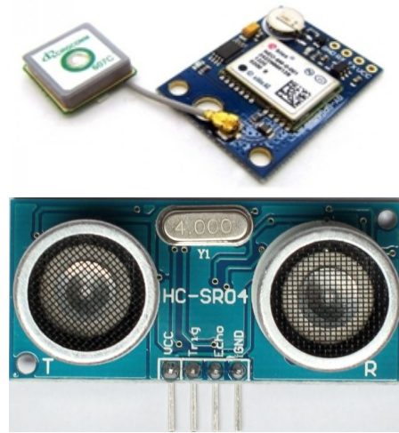
Şekil 2: Robot üzerindeki GPS ve mesafe modülleri.
