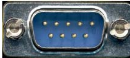
Şekil 3.2 RS232 DB-9P Konektörün Fiziksel Görünüşü[6].
