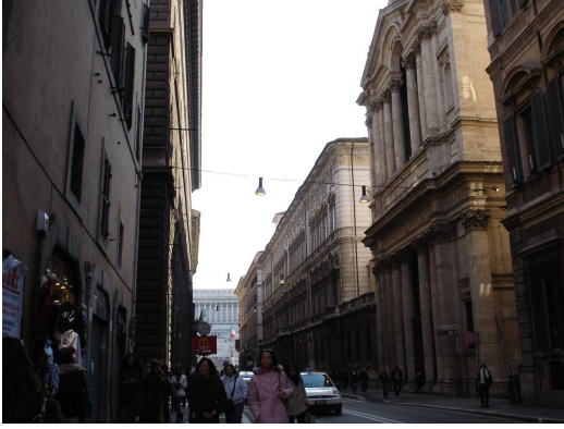
Şekil 8. Armatürlerin düzgün gerilmiş sistemlere asılması-Roma
