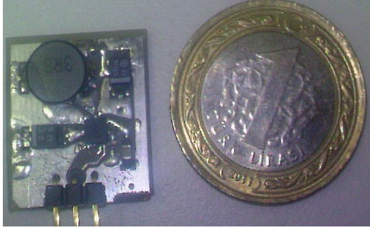
Şekil 4. Uygulanmış yükseltici devresi
