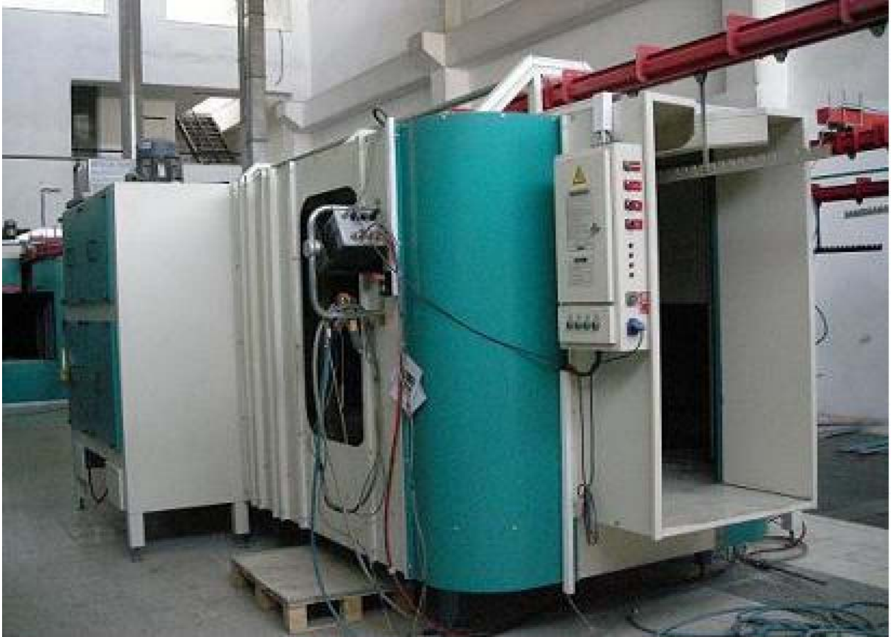
Ek-00: Toz boya kabini görünüşü
