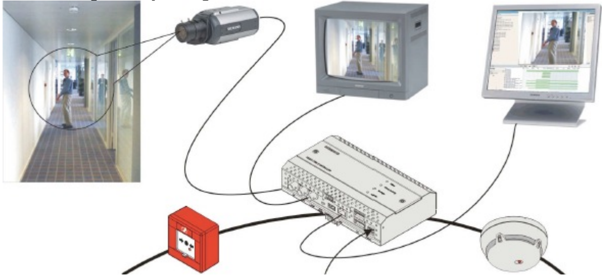
Şekil-2 : Video kontrol cihazı prensip bağlantı şeması
