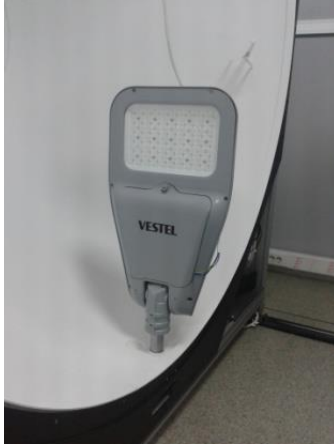
Resim 6: VESTEL M4 Street Light ürününün Bütünleştirme Küresi'ndeki konumu.
