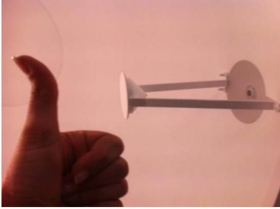
Resim 2: Detektör ve detektöre direkt ışığın gelmesini engelleyen levhalar.
