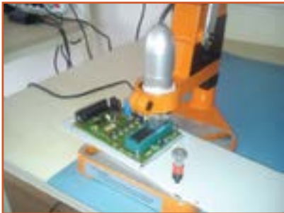
Resim 4.11. Testte kullanılan dijital mikroskop platformu.
