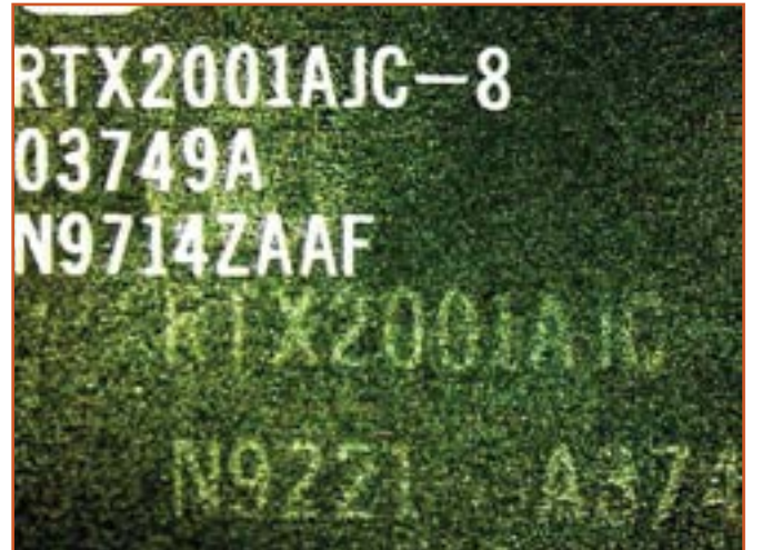
Resim 4.1. Altında orijinal yazısı silinip, yeniden isimlendirilmiş taklit veya kullanılmış malzeme.
