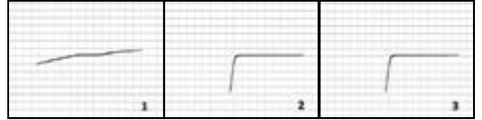
Şekil 4.12. Orijinal-2 LF353 1,2 ve 3 pinleri VI eğrileri.
