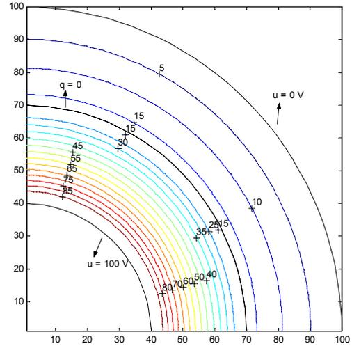
Figure 10. The Equipotential contours
