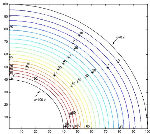
Figure 8. The Equipotential contours
