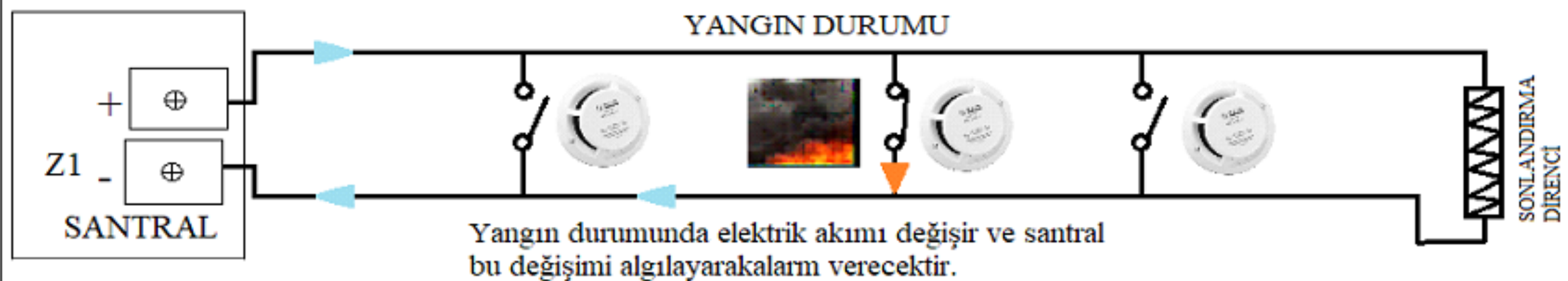
Resim 3-08b: Paralel bağlı sistem çalışma prensibi
