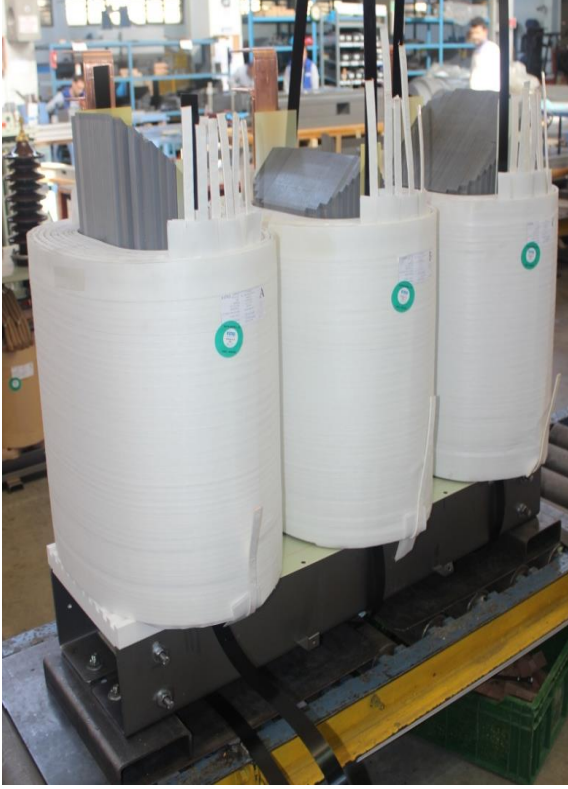
Şekil.4. Yüksek ısıl dayanımlı yalıtım malzemesiyle sarılmış bobinler
