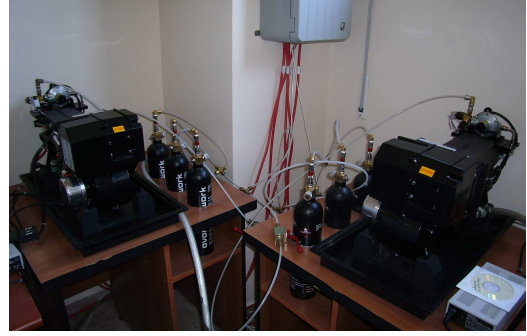
Şekil 6: Sistemde kullanılan paralel bağlı yakıt pilleri
