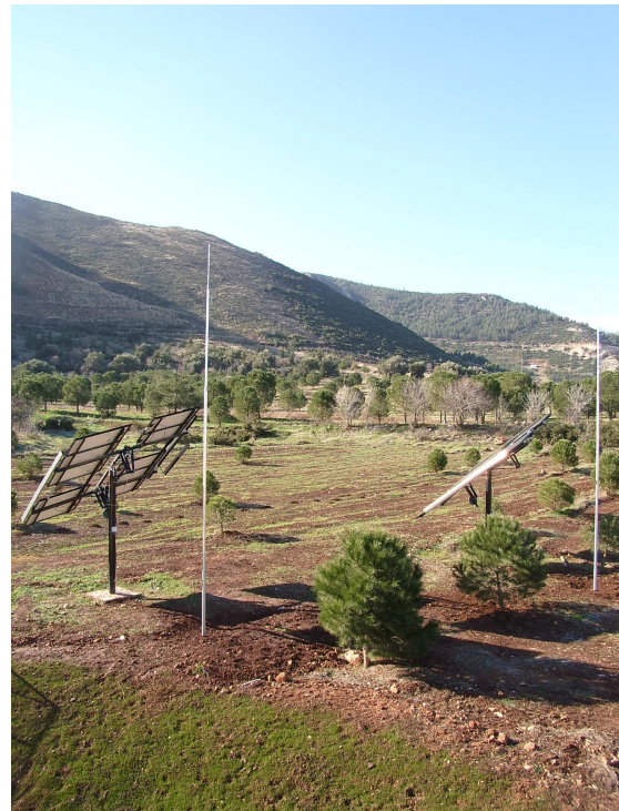
Şekil 3. Sıvı bazlı güneş takip düzeneği üzerindeki fotovoltaik paneller.
