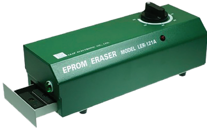
Resim 6.2. EPROM Eraser (silici) görünümü.
