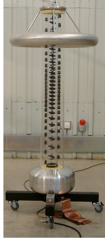
Şekil 3. 100 kV'luk referans gerilim bölücüsü
