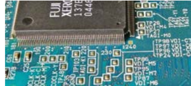
Resim 1. Bir elektronik kontrol kartı üzerindeki TP noktalarından bazıları
