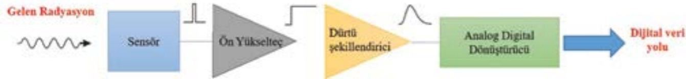
Şekil 1. Temel dedeksiyonun çalışma prensibi
