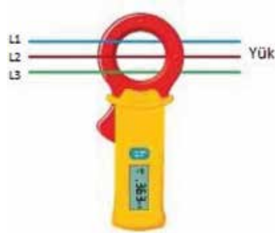
Şekil 5- Üç fazlı besleme için ölçüm yöntemi
