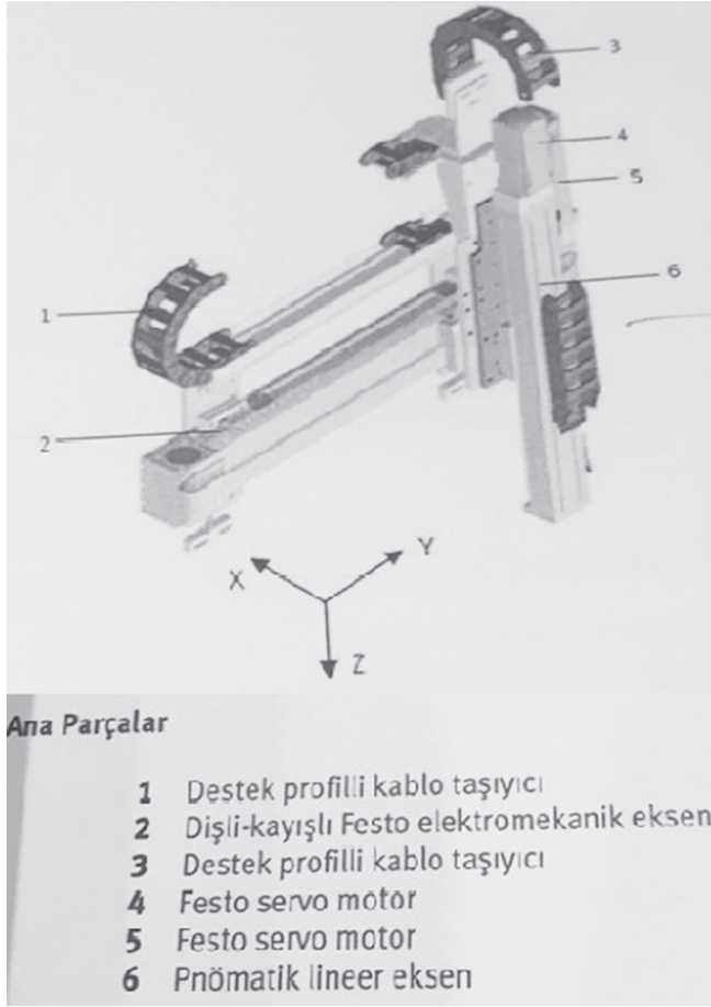
Sekil-1 Sözleşmede tanımlı “2 Eksenli Handling sistemi ve Servomotorlu elektromekanik eksen” şeması
