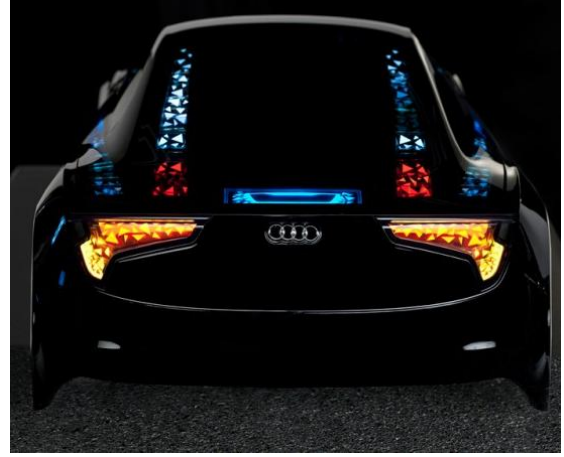
Şekil 7: OLED teknolojisiyle donatılmış prototip araç.
