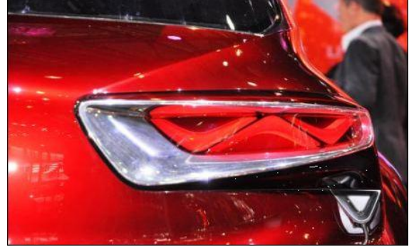
Şekil 2: Işık duvarı kullanılan bir LED'li stop
