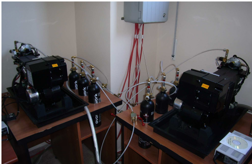
Şekil 12: Sistemde kullanılan paralel bağlı yakıt pilleri.
