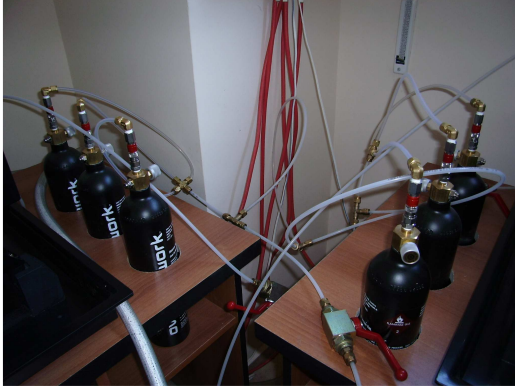
Şekil 15: Metal hidrid hidrojen tankları.
