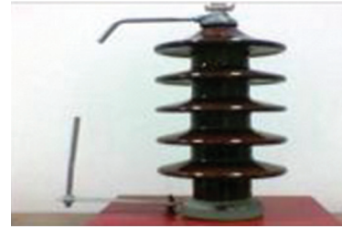
Resim 1: Transformatör buşingi ve eklatörü (ark boynuzu)
