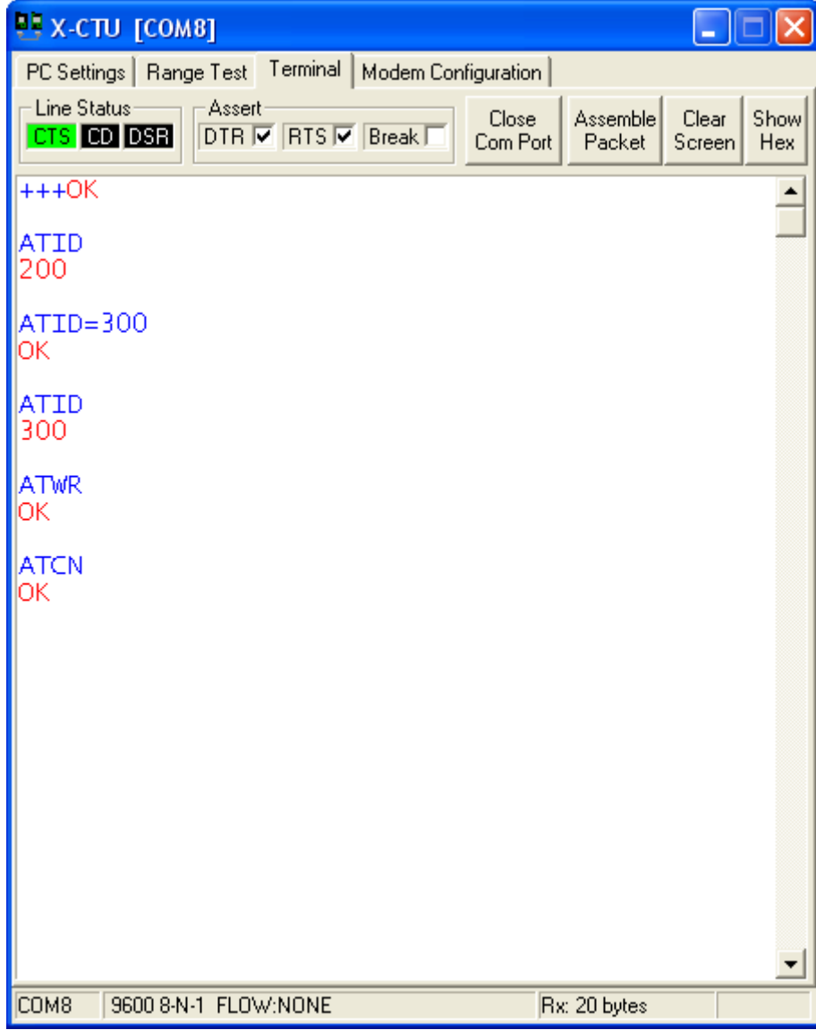
Şekil 4.5 : Terminal Sekmesinde PAN ID Konfigürasyonu
