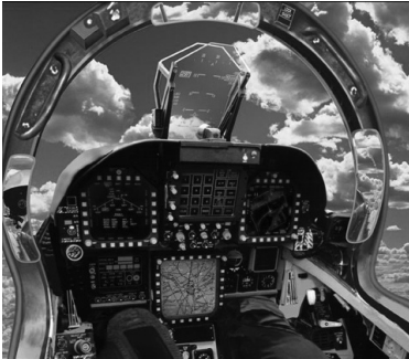
Fotoğrafta bir F18-E savaş uçağının cockpit’i görülmektedir. Kaynak: http://commons.wikimedia.org/wiki
