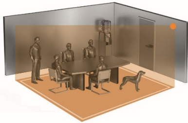
Şekil 2 – Algilama alanını isteğe bağlı olarak belirleme ve sadece insan algılaması
