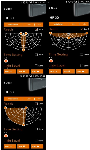
Şekil 15 - Gelişmiş Yüksek frekans sensörünün mobil uygulama üzerinden menzil ve hassasiyetinin ayarlanması
