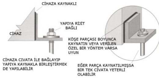
Şekil 13. Köşe takviye parçasının ekipmana kaynatılması [4]
