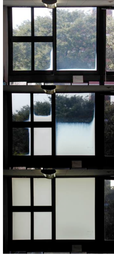
Şekil 1 Termokromik camın değişik durumlarda görünümüleri [5]
