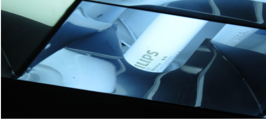
Şekil 2: 4x18W Parabolik Reflektörlü Armatürler Optik Kusurları
