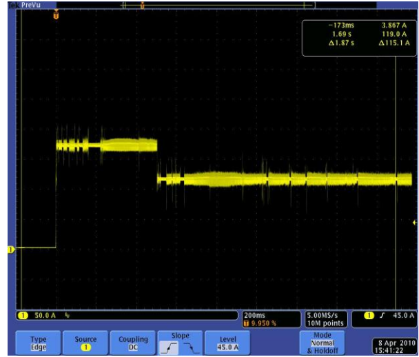
Şekil 16: Kaynak işleminde 0.5 s süreli sıcak başlangıç süreci (kaynak akımı).
