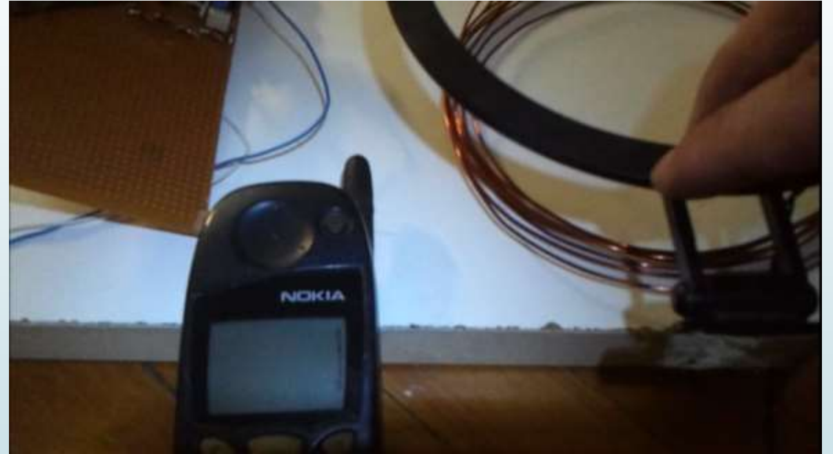
Nokia 5110 için kablosuz şarj deneyimiz, ~6cm
